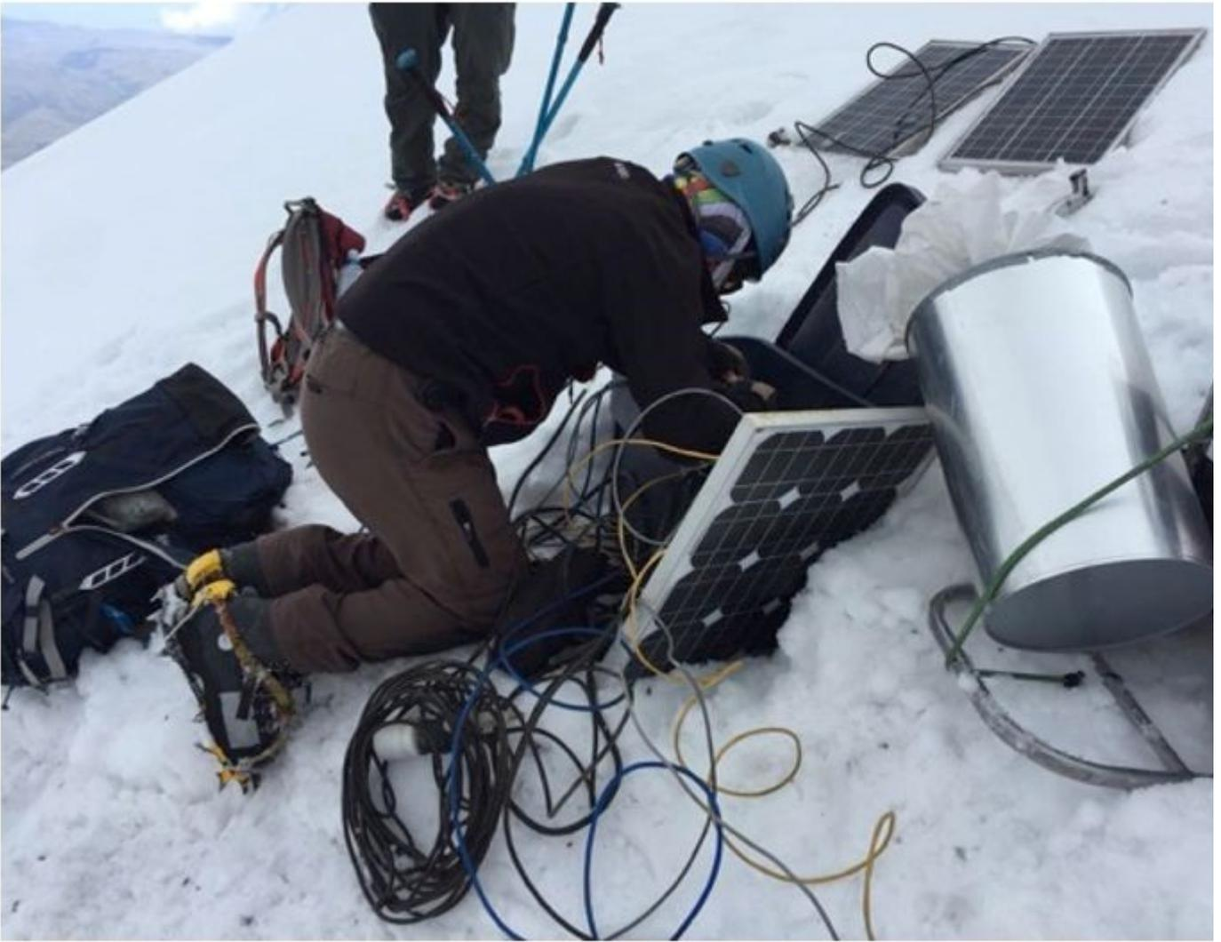
Installation d'un capteur sismique sur le glacier a une altitude de 5160 m (Photo: F. Vásconez - IG-EPN)
