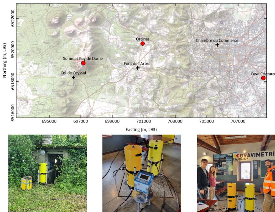
Fig. 6. Mesures gravimétriques absolues et relatives sur la ligne d'étalonnage Cézeaux-Puy de Dôme (mai 2025)
